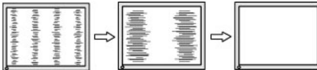
4. Después de ajustar el Reloj, si aparece borrosidad, movimiento rápido o barras en pantalla, continúe para ajustar la Fase.
