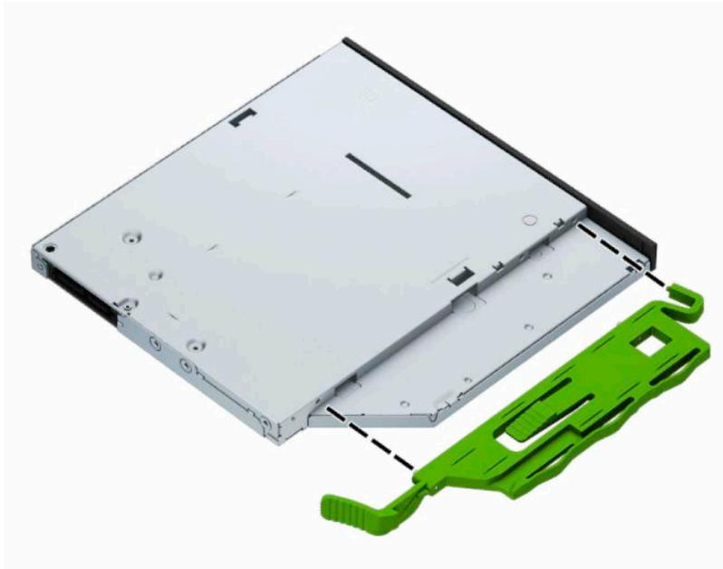
6. Deslice la unidad óptica a través de la cubierta frontal (1) hasta introducirla totalmente en el compartimento, de forma que la pestaña verde quede encajada en el marco del chasis (2).
