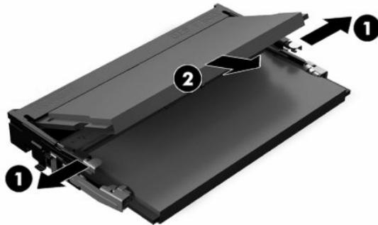
3. Deslice el nuevo módulo de memoria en la ranura (1) en un ángulo de aproximadamente 30 grados y luego presione el módulo de memoria hacia abajo para que los pestillos (2) de bloqueo encajen en su sitio.
