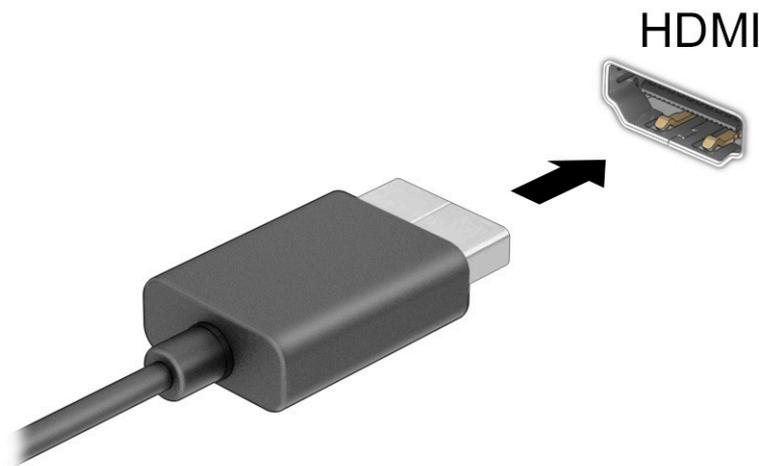
2. Conecte el otro extremo del cable a la TV o monitor de alta definición.
