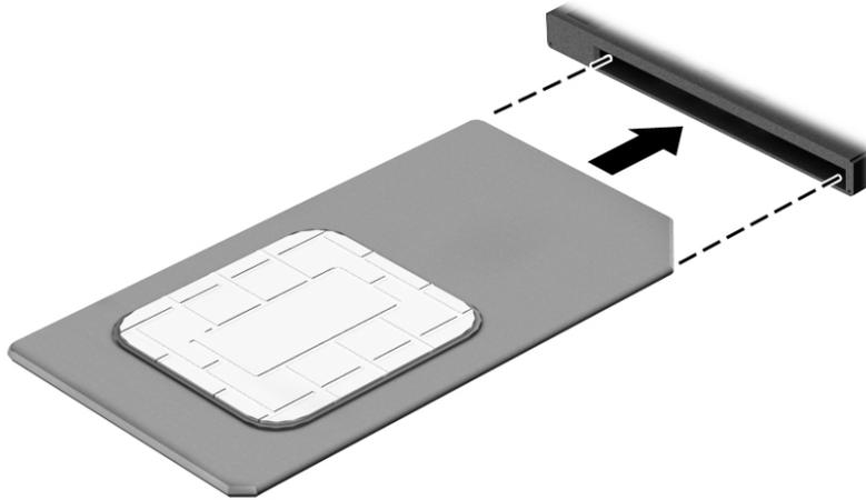
Para extraer una tarjeta SIM, presiónela y luego extráigala de la ranura.
