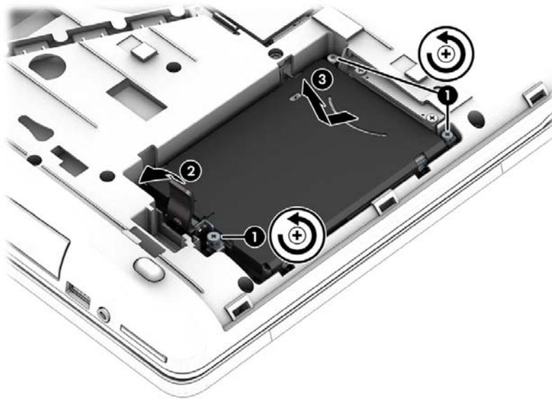
7. Levante la unidad de disco duro (3) y tire de la unidad de disco duro hacia fuera del compartimiento.
